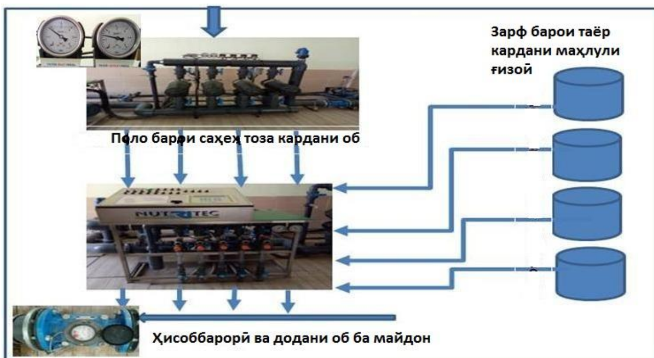
Расми 3.5. - Гиреҳи назорати обёрӣ ва ғизодиҳии минералии системаи обёрии қатрагӣ дар қитъаи таҷрибавии ҷамъияти дорои масъулияти маҳдуди “Ситабр Агро”
