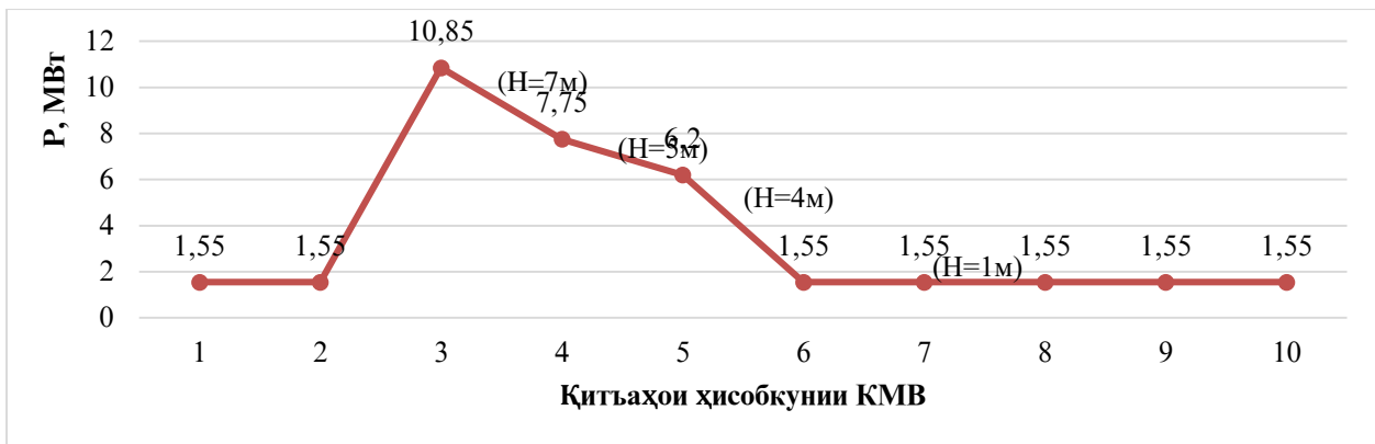
Расми 4. - Таносуби тавноии потенциали гидроэнергетикии КМВ аз фурудои ҳақиқии он дар қитъаҳои ҳисобшуда
