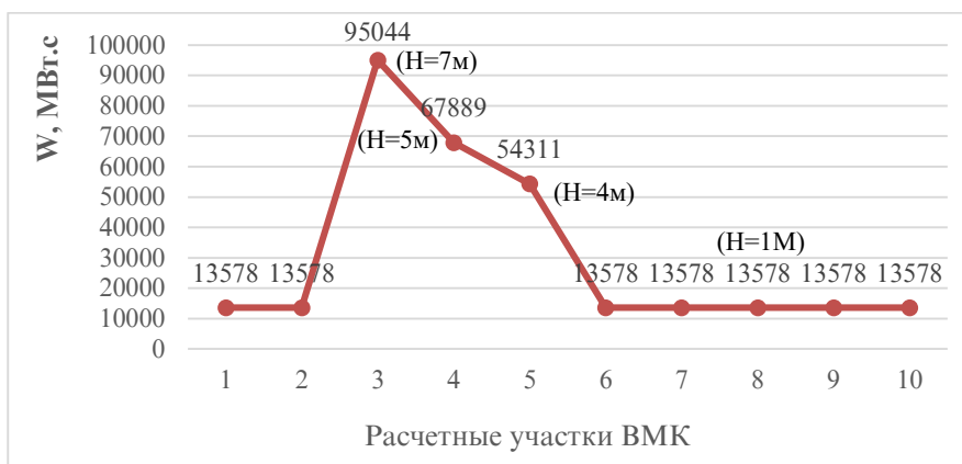
Рисунок 5. График потенциальной гидроэнергетической энергии ВМК на 10 расчетных участках канала
