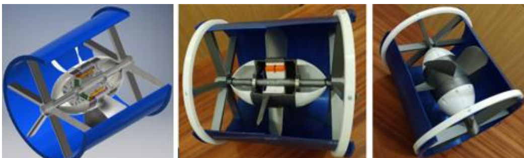
Расми 3.4. Аксҳои модели-амсилаи миқёсии генератори ангиши омехта барои НБОХ, ки бо технологияи 3D тайёр гардидаанд.
