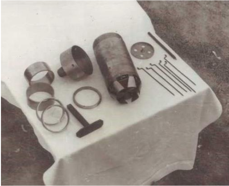
Рисунок 2. Конструкция грунтоотборника: а) - в разобранном виде, б) - в собранном виде с закрытой грунтоприемной камерой
