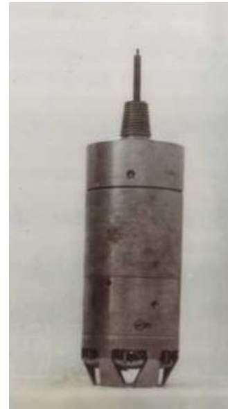
Рисунок 2. Конструкция грунтоотборника: а) - в разобранном виде, б) - в собранном виде с закрытой грунтоприемной камерой
