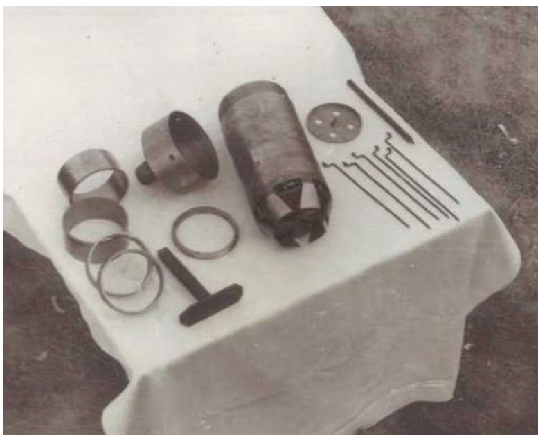
Рисунок 2.4. - Конструкция разработанного грунтоотборника: а) - в разобранном виде, б) - в собранном виде с закрытой грунтоприемной камерой
