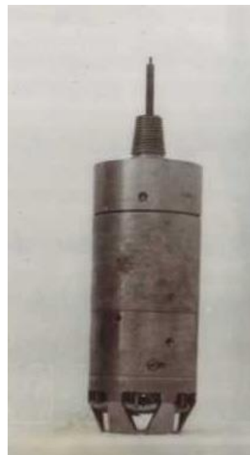
Рисунок 2.4. - Конструкция разработанного грунтоотборника: а) - в разобранном виде, б) - в собранном виде с закрытой грунтоприемной камерой
