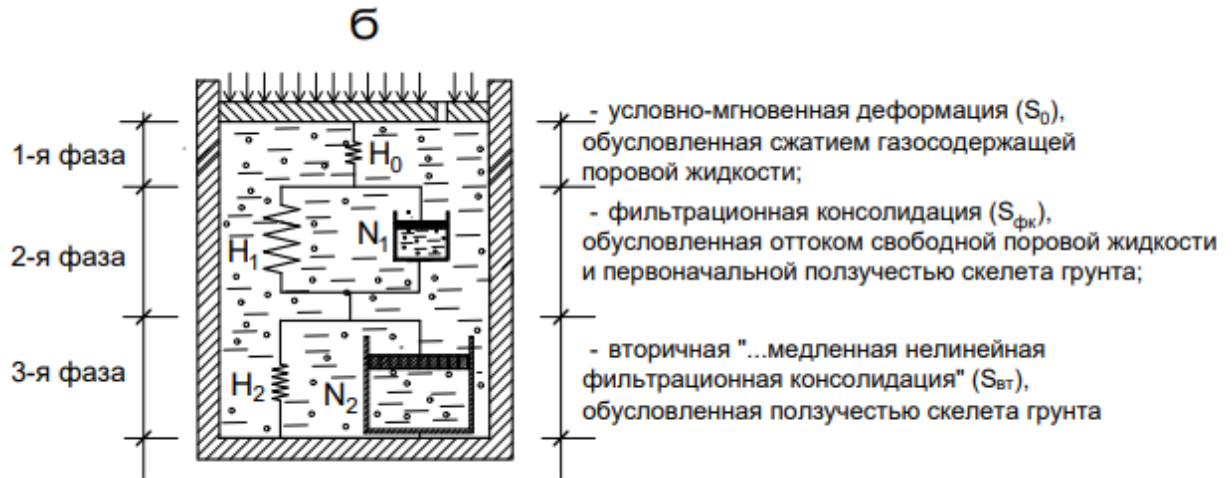
Рисунок 6.11. - Механическая модель консолидации водонасыщенного глинистого грунта; H_0, H_1, H_2 - упругие элементы Гука, N_1, N_2 - вязкие элементы Ньютона (размеры элементов приведены условно согласно их влиянию на фазу консолидации)
