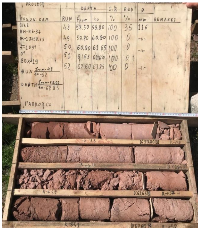
Рисунок 2.14: Скважина RE-37 – Зона сдвига разлома 35 на глубине 59.90 до 62.85м.
