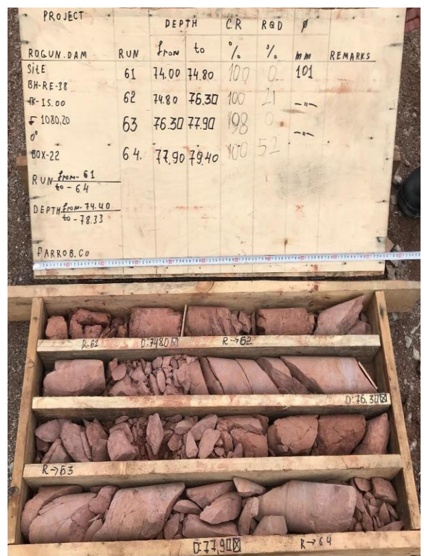
Рисунок 2.17. Скважина RE-38. Зона сдвига разлома 35 на глубине 74.40 до 75.20
