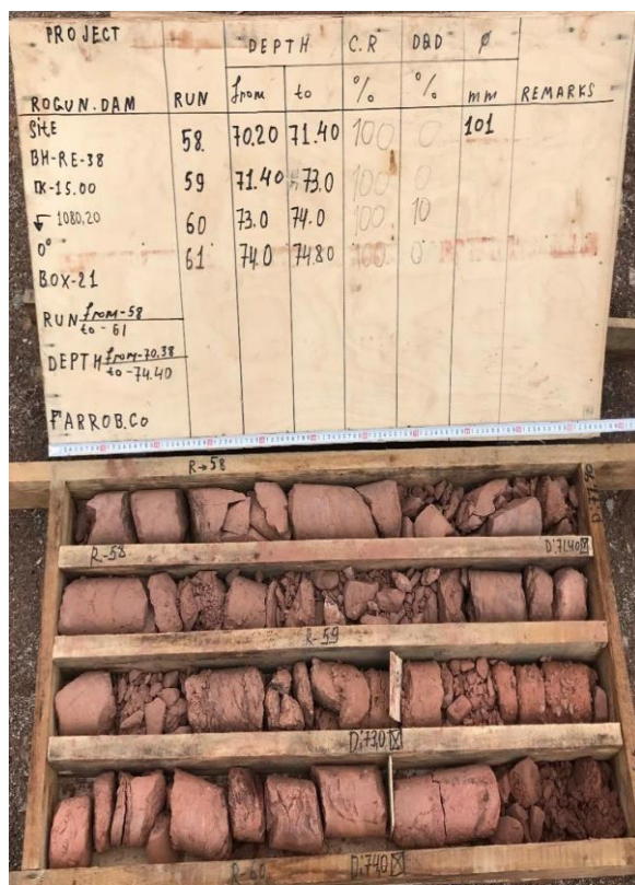
Рисунок 2.16. Скважина RE-38. Зона сдвига разлома 35 на глубине 71.30 до 74.40
