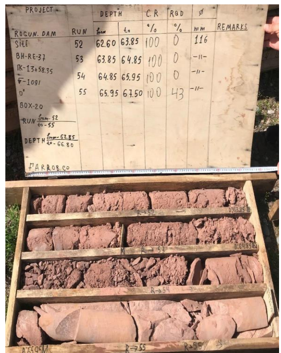
Рисунок 2.15: Скважина RE-37 – Зо на сдвига разлома 35 на глубине 62.85 до 66.55м.
