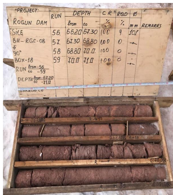
Рисунок 2.21. Сквжина RGC-08 – зона сдвига разлома на глубине 67.2 до 71.0 м
