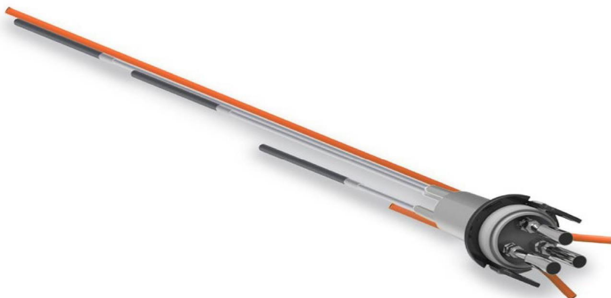
Рисунки 3.31. Схематическое изображение экстензометра с многоточечными стержнями
