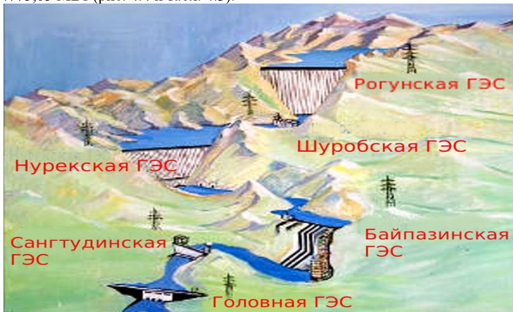
Рис. 4.4. Схема расположения каскада ГЭС на реке Вахш
